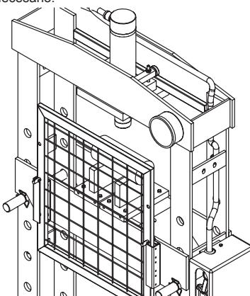
2. Coloque las placas de sujeción (18) sobre el marco. Coloque la pieza de trabajo sobre el marco o sobre el tablero. Actúe con precaución para garantizar la seguridad y evitar accidentes. Estabilice la pieza de trabajo de una manera en la que no pueda caer accidentalmente de la mesa de la prensa una vez que la carga es removida.
