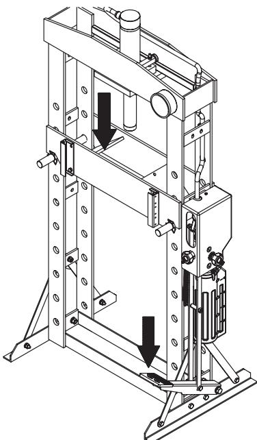
5. Tournez la soupape d'évacuation et la soupape rapide/lente dans le sens contraire des aiguilles d'une montre.
