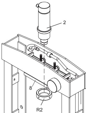
7. Connectez le raccord mâle du tuyau hydraulique (33) à l'assemblage du cylindre (2).
