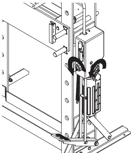
6. Puis appuyez sur la pédale rapidement, lorsque la tige du piston est en train de retourner jusqu'à ce qu'elle retourne à la position originale afin de faire sortir l'air du système hydraulique.
