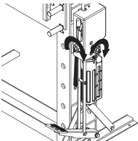
4. Pise sobre el pedal para extender un poco la varilla del pistón.
