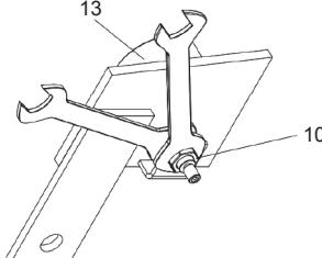
5. Placez l'embout du tuyau hydraulique sur l'assemblage du tuyau (45). Installez le joint torique (9) dans la rainure de l'embout du raccord du tuyau (45). Puis connectez le tuyau hydraulique (45) au manomètre (13). Serrez bien l'embout du tuyau (45) sur le manomètre (13).
