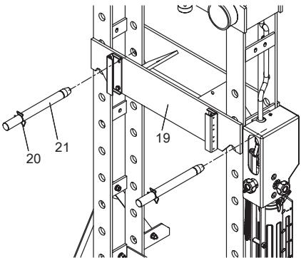
9. Coloque las placas de sujeción (18) sobre el travesaño inferior (19).
