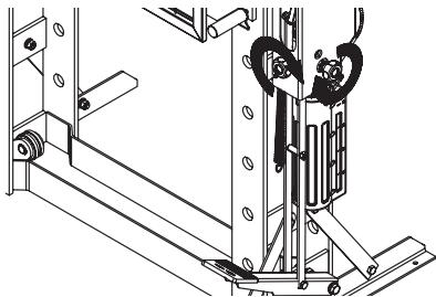
6. Pompez la poignée ou la pédale jusqu'à ce que la crémaillère s'approche de la pièce à travailler. Puis, ouvrez la soupape rapide/lente en la tournant dans le sens contraire des aiguilles d'une montre.
