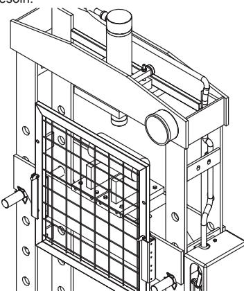
2. Mettez les plateaux mobiles (18) sur l'encadrement. Mettez la pièce à travailler sur l'encadrement ou sur le bloc de pressage. Agissez avec précaution afin d'assurer la sécurité et d'éviter des accidents. Positionnez la pièce à travailler de façon à empêcher qu'elle tombe accidentellement de l'encadrement ou du bloc de pressage.
