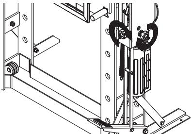
6. Bombée la palanca o el pedal hasta que el asiento dentado se acerque a la pieza de trabajo. Luego, abra la válvula rápido/lento girándola en sentido antihorario.
