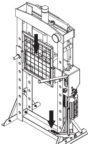
9. Lorsque le travail est fini, arrêtez de pomper la poignée. Puis lentement tournez la soupape d'évacuation dans le sens contraire des aiguilles d'une montre jusqu'à ce que le vérin soit libre de la pièce à travailler.
