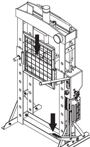
9. Cuando la tarea haya sido completada, deje de bombear la palanca. Luego lentamente gire la válvula de liberación en sentido anti horario en pequeños incrementos hasta que el cilindro quede liberado de la pieza de trabajo.
