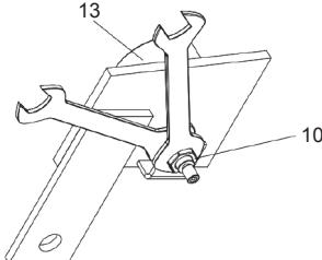
5. Coloque la conexión de la manguera hidráulica en el ensamblaje de la manguera (45). Instale la junta tórica (9) en la ranura del accesorio de conexión de la manguera (45). Luego conecte la manguera hidráulica (45) al manómetro (13). Ajuste bien la conexión de la manguera (45) al manómetro (13).
