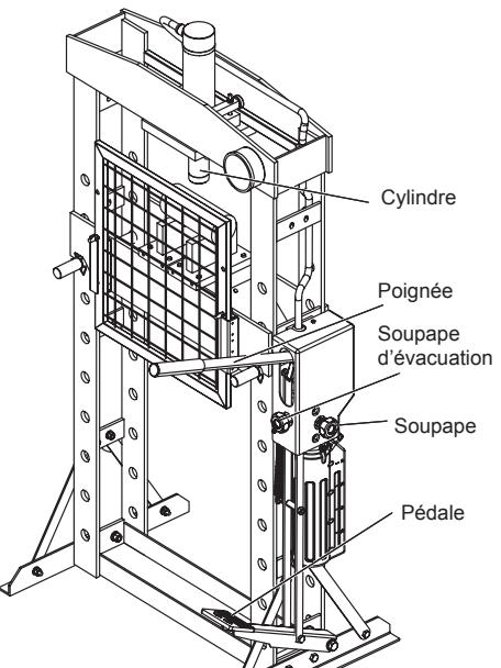
5. Fermez la soupape d'évacuation et la soupape rapide/lente en les tournant dans le sens des aiguilles d'une montre jusqu'à ce qu'elles soient bien fermées.
