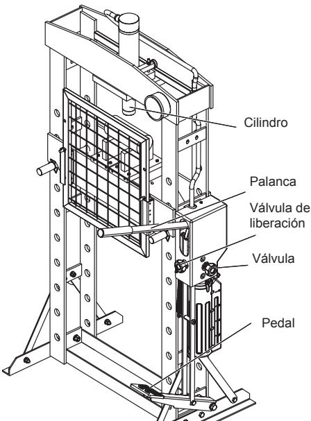
5. Cierre la válvula de liberación y la válvula rápido/lento haciéndolas girar en sentido horario hasta que queden bien cerradas.
